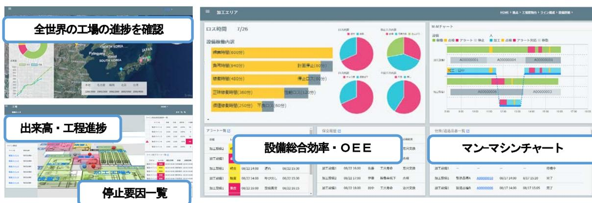
図1：工場 IoT データを可視化する「Visual Factory」の画面例
